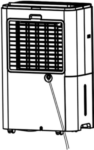
Wenn ein Ablauf vorhanden ist, kann das Kondenswasser auch direkt über einen angeschlossenen Schlauch abgeführt werden (Innendurchmesser 10mm). Das Gerät verfügt über keine Pumpe. Der Ablauf muss daher tiefer, als der Schlauchanschluss liegen. Der
